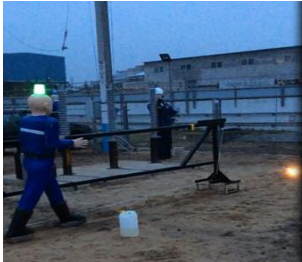
Стенд падение провода на землю (шаговое напряжение превысило допустимое значение)
